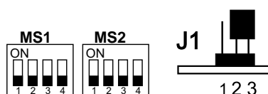
Position der DIP-Schalter MS1, MS2 und des Brückensteckers J1 zum Beenden des Programmiermodus
